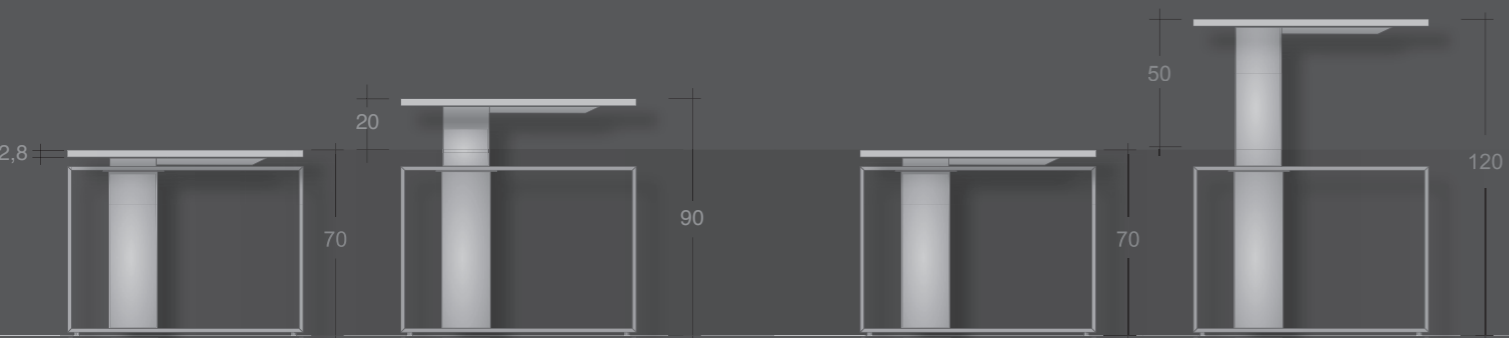
Arbeitstisch höhenstellbar 70-90 cm work station initial height adjustable
